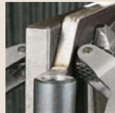
2 Шероховатая поверхность Увеличивает трение на поверхности прижима.
