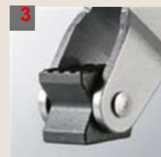
3 V-блок Подходит для захвата круглых деталей.
